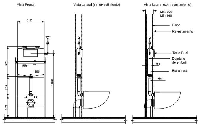
\* Incluye todos los elementos para la instalación del inodoro suspendido y depósito para embutir Suma (no incluye tecla selectora).
