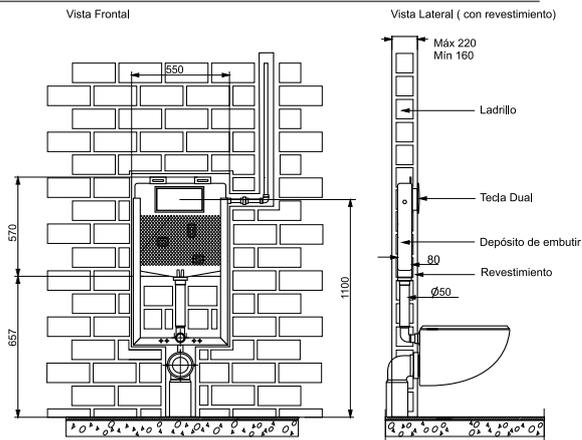
\* Incluye todos los elementos para la instalación del inodoro suspendido y depósito para embutir Suma (no incluye tecla selectora).
